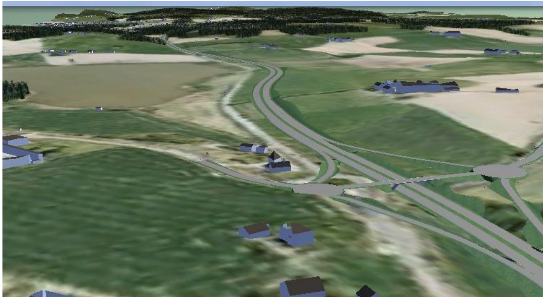
Figur 17: E18 Vinterbro - Akershus grense. Alternativ 1A, 1 B og 3A-1. Topplanskryss ved Holstad og firefelts E18 som dagstrekning langs Østensjøvannet. Dagens E18 blir liggende uendret, og blir lokalvei. Felleskjøpet i venstre kant av bildet, mens Østensjøvannet er den brun/grå flaten til venstre. Prestegårdsskogen øverst.
