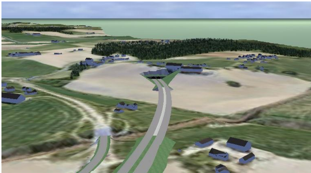
Figur 16: E18 Vinterbro - Akershus grense. Alternativ 3A_3, 3A_4 og 3A_5. Ny bru over jernbanen som avsluttes rett før tunnel under Holstad. Nedre Holstad gård til venstre i bildet, Øvre Holstad til høyre. Dagens E18 opprettholdes og blir lokalvei, vist til venstre for firefeltsveien i bildet.
