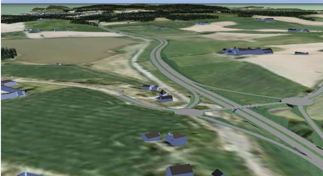
Figur 17: E18 Vinterbro - Akershus grense. Alternativ 1A, 1 B og 3A-1. Toplanskryss ved Holstad og firefelts E18 som dagstrekning langs Østensjøvannet. Dagens E18 blir liggende uendret, og blir lokalvei. Felleskjøpet i venstre kant av bildet, mens Østensjøvannet er den brun/grå flaten til venstre. Prestegårdsskogen øverst.
