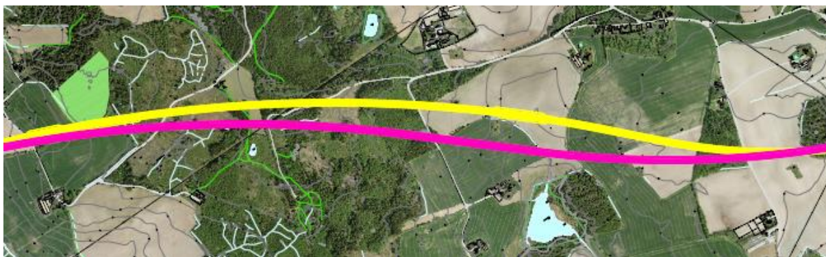
Figur 12 Aktuelle løsninger i Glenneområdet som skal vurderes i reguleringsplanarbeidet. Rosa linje er vedtatt korridor fra kommunedelplanen, mens gul linje er en alternativ løsning som skal optimaliseres og vurderes i det videre arbeidet med reguleringsplan.
