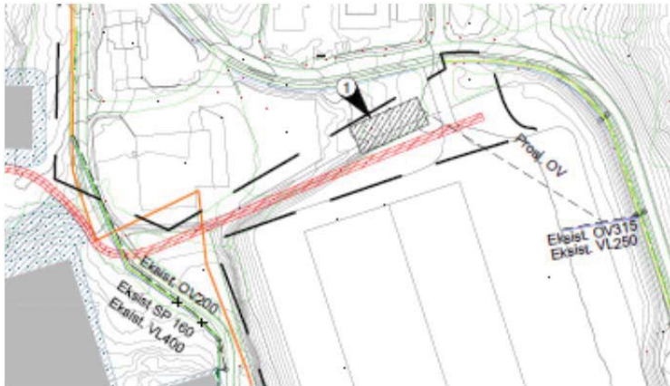
Figur 17 Forslag til plassering av fordrøyningsbasseng
