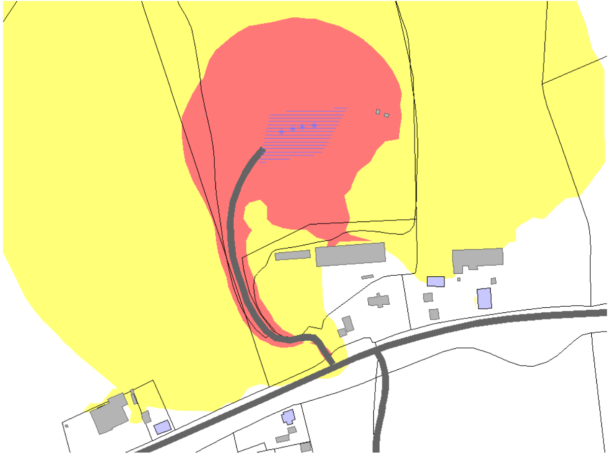
Figur 4 Støysonekart L_{den} for drift mandag-fredag, beregningshøyde 2 meter. Grenseverdier iht. T-1442: Gul sone L_{den} \geq 50 dB og rød sone L_{den} \geq 60 dB.
