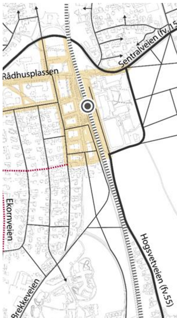
Figur 3. Foreslått gatenett for biltrafikk sør for sentrum, med stenging av Brekkeveien og etablering av ny undergang
