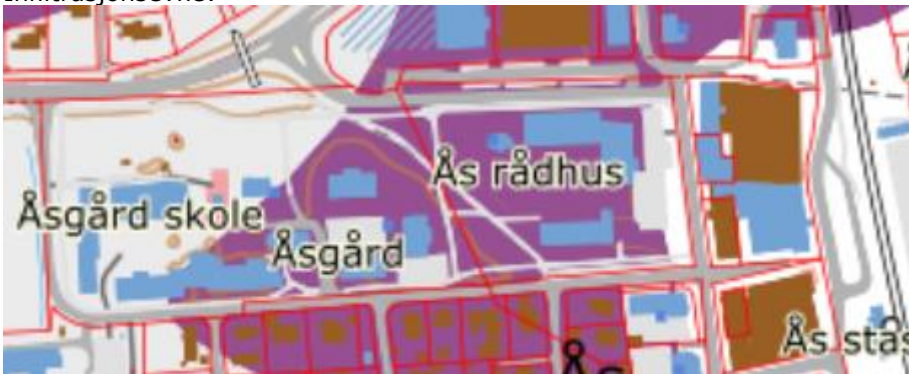
Figur 6 viser infiltrasjonsevnen for planområdet (kilde: NGU.no).
