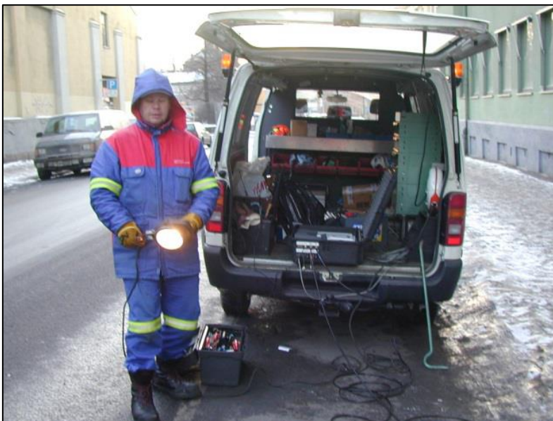
Figur 11 Eksempel på bil med utstyr for måling, sanntidsovervåking og driftskontroll av VA-ledningsnett (fotokilde: Presentasjon på Norsk Vanns årskonferanse 1-2. september 2015, Kristiansand).
