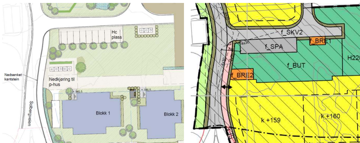
Figur 25. Plassering av renovasjon er vist i illustrasjonplanen (utsnitt til venstre) og i plankartet (utsnitt til høyre – arealformål f_{BRE1} og f_{BRE2} ).
