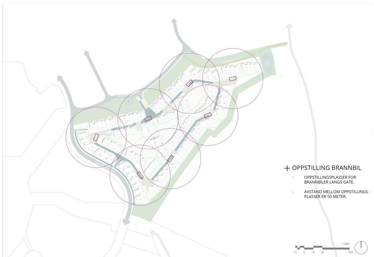
Figur 16 Plan som viser oppstillingsplasser for brannbil.
