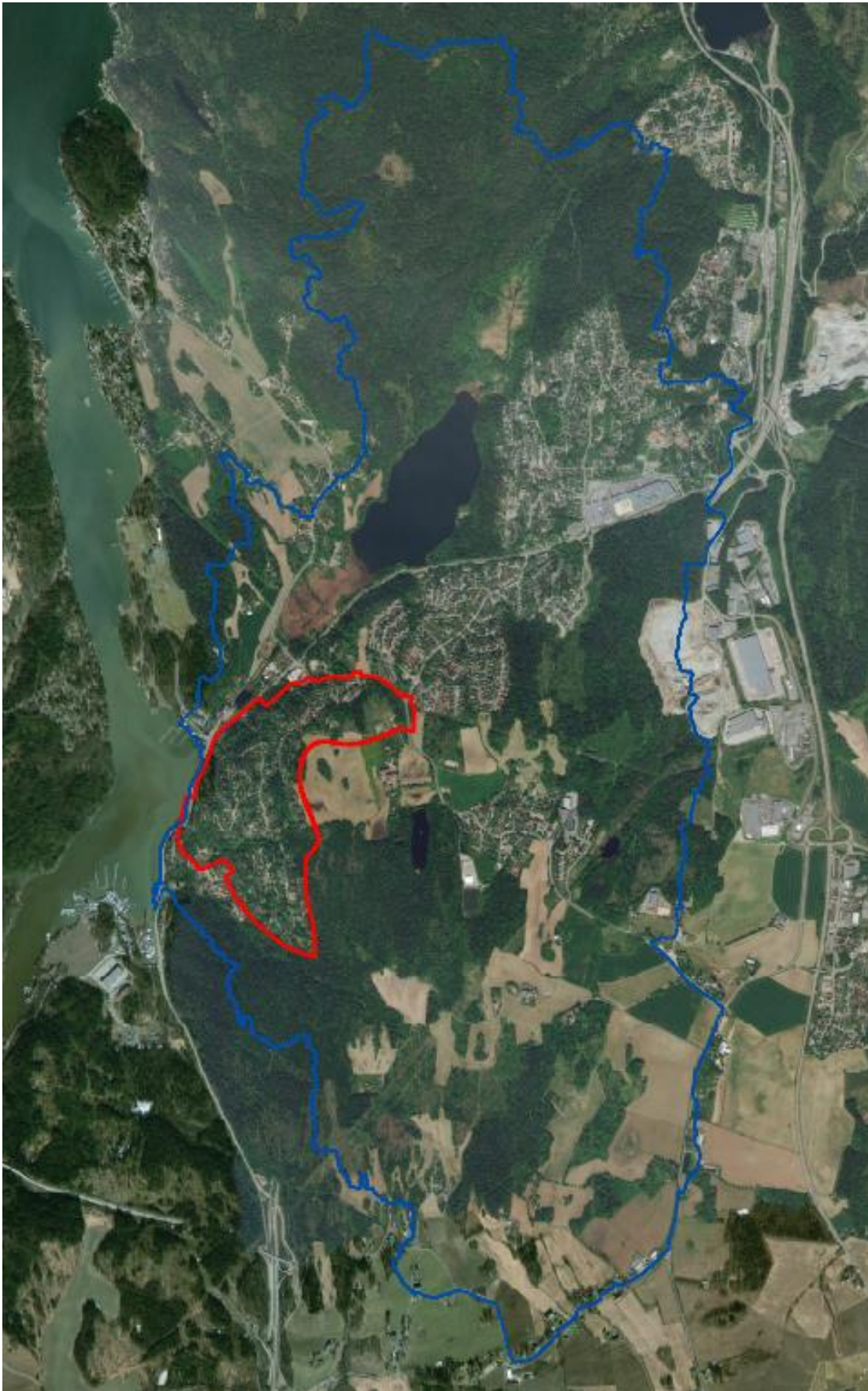
Figur 5. Avgrensning av nedbørfelt benyttet i overvannsmoellene vist i blått, avgrensning av planområdet vist i rødt. Flyfoto datert 27.05.2017.
