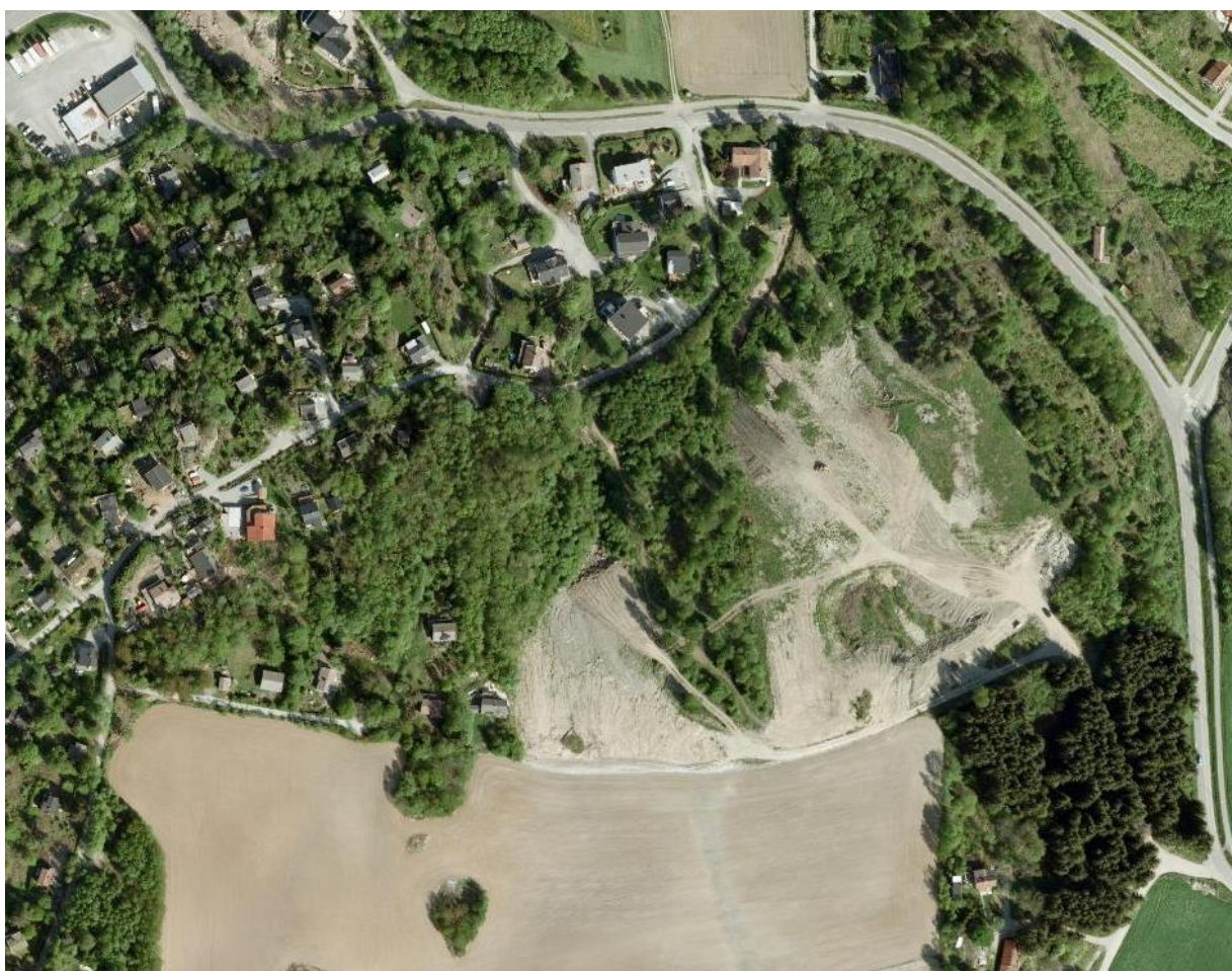
Figur 3. Flyfoto fra 2008 hentet fra Finn.no. Bildet viser fyllmasser over store deler av området Askehaug gård.
