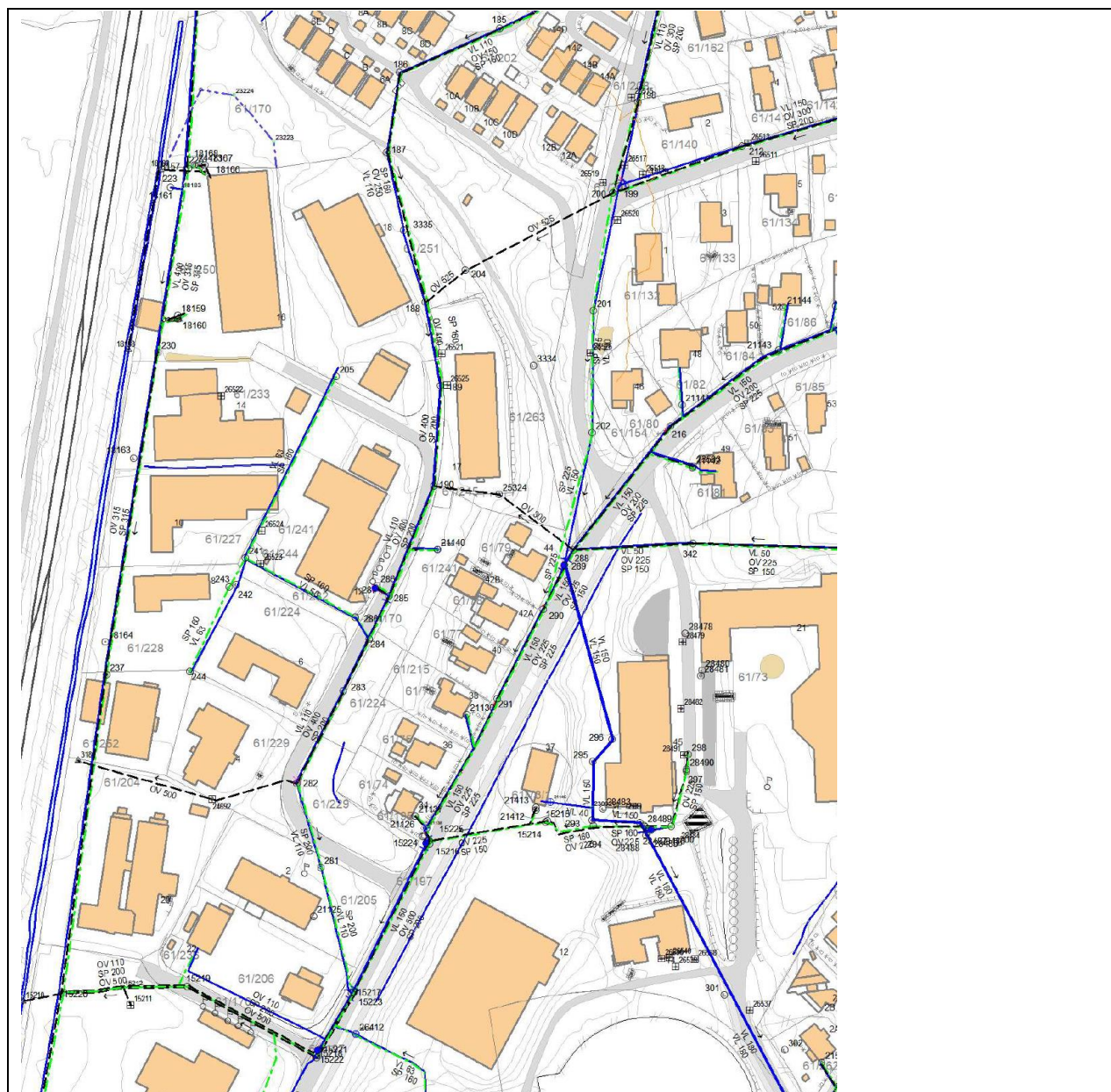
III.12 Plan som viser dagens ledningsnett. Nettet har god kapasitet og kan betjene Langbakken Nord fra et hovedstreck med vann og avløp som ligger langs jernbanelinjens østre side. Rørnettet for overvann har ikke tilstrekkelig kapasitet for å håndtere nedbørsmengdene som følger av klimaendringer. Det kommer overvannsledninger inn i planområdet fra høyere liggende områder øst for planområdet, og disse må inngå i fremtidige løsninger.
