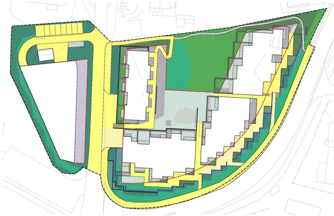
Figur 27. Visuell oversikt av type flater som inngår i beregning av blågrønn faktor for illustrasjonsprosjektet.
