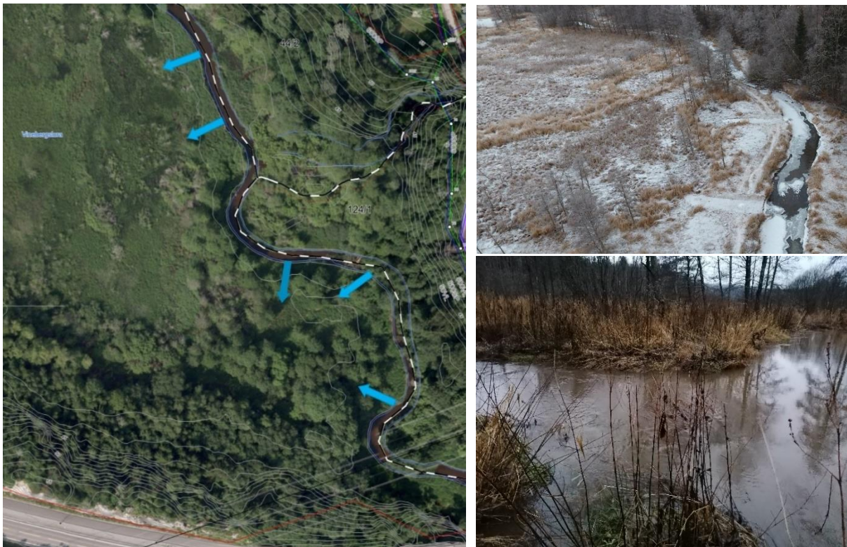
Figur 11: T.v.: Oversikt over plasseringen til de kanalene som ble laget i vollen og senere gjenåpnet i 2016. T.h. øverst: To av kanalene som ble åpnet vinteren 2016. Nede t.h.: Den nest nordligste av kanalene i funksjon november 2020. Bildet er tatt med Dalsbekken i ryggen og ser utover våtmarken i pilens retning (ref. bildet til venstre)
